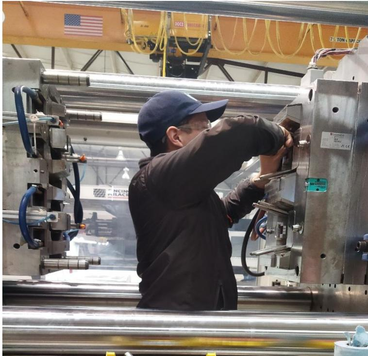
Figura 60: Evidencia de efectucción de cambio de insertos.
